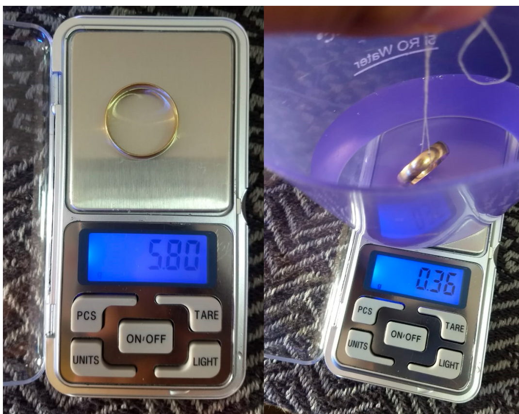
Figura 5 – Determinação da Densidade de uma Aliança de Ouro 18 quilates
