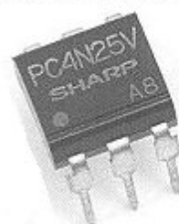
ASPECTO REAL DE UM FOTOACOPLADOR DE 6 TERMINAIS
