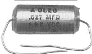
CAPACITOR A ÓLEO
